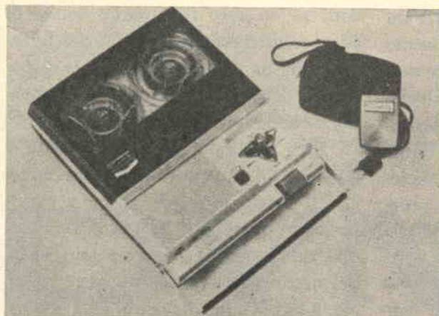
Registratore Craig "212", bobine da 8 cm, due piste, due velocità (9,5 cm/sec e 4,75 cm/sec); funziona con sei pile, è dotato di un controllo automatico del livello ed avvolgimento e riavvolgimento rapido; può essere azionato a distanza; dimensioni 20 x 24,5 x 8 cm, peso circa 2 kg.
