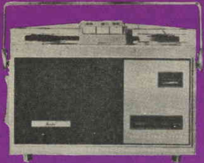
Registratore Norelco "Continental 101", bobine da 10 cm, due piste, velocità 4,75 cm/sec; funziona per quaranta ore con sei pile; è dotato di un indicatore combinato per il livello audio e le condizioni delle pile; è azionabile a distanza; dimensioni 20 x 28 x 9,5 cm, peso 3,2 kg.
